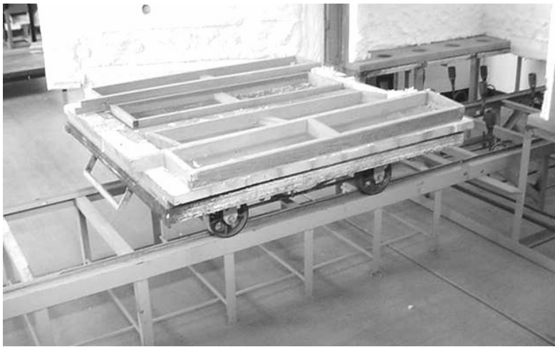
Figura 2.3. Interior del horno, riel y carro.
