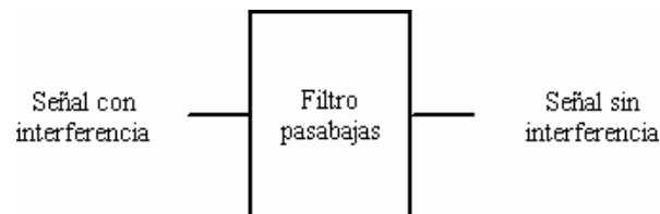
Figura 4.9 Supresión de la interferencia mediante filtro pasabajas.
