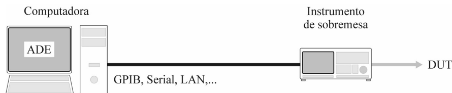
Figura 2.2. Esquema básico para control de instrumentos de sobremesa.
