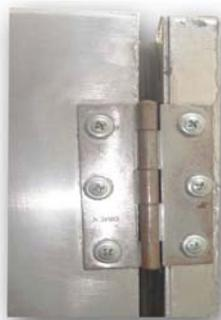
**Foto 6.** Bisagra colocada en la puerta del secador.
