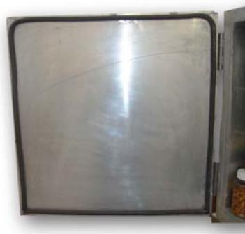
**Foto 5.** Empaque colocado en la puerta del secador.
