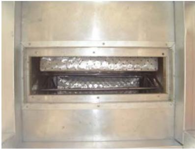
**Foto 4.** Vista inferior de la cámara de secado mostrando el ángulo de aluminio.
