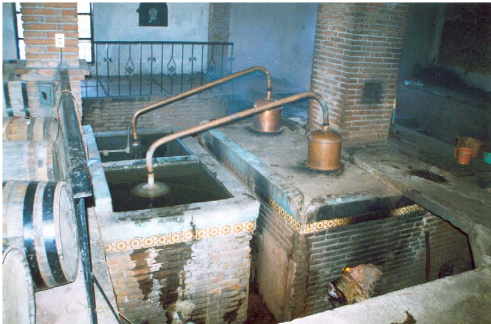
Figura 7. Destilación y obtención del mezcal
