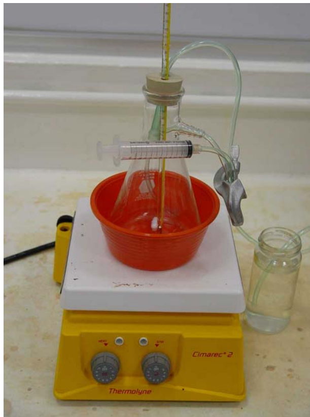
Figura 11. Reactor para la fermentación de mosto
