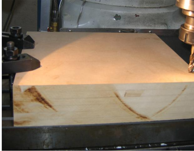
**Fig. 5.6** Bloque de MDF para maquinado de molde
