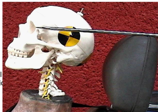
**Fig. 3.8** Nivel óptimo del reposacabezas
