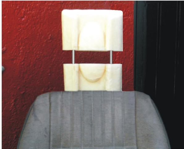
**Fig. 5.21** Dispositivo ajustable con barras de ajuste, huecos y clip de fijación
