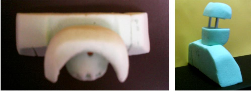
**Fig. 4.12** Vista superior, y barras ajustables de reposacabezas
