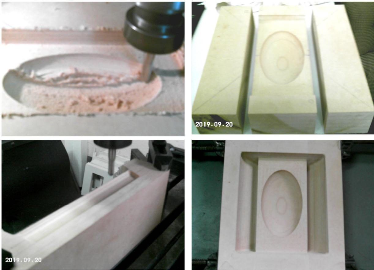
**Fig. 5.10** Izda. superior maquinado de la parte central, dcha. superior corte de los laterales, izda. inferior maquinado de los ángulos negativos de la parte central, dcha. inferior parte frontal terminada con los laterales previamente maquinado
