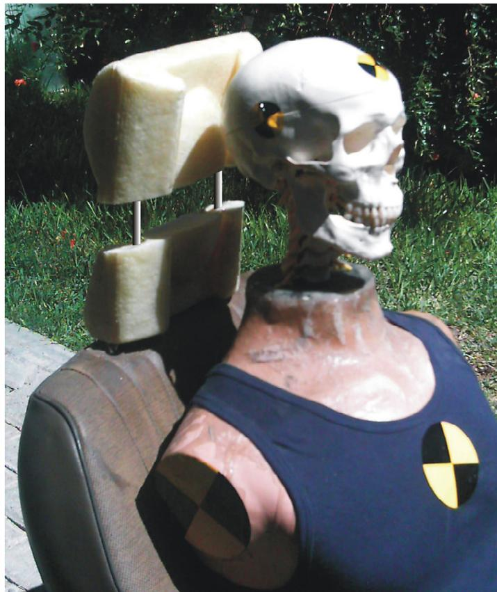
**Fig. 5.20** Montaje del prototipo volumétrico con respecto a un dummy de percentil 95
