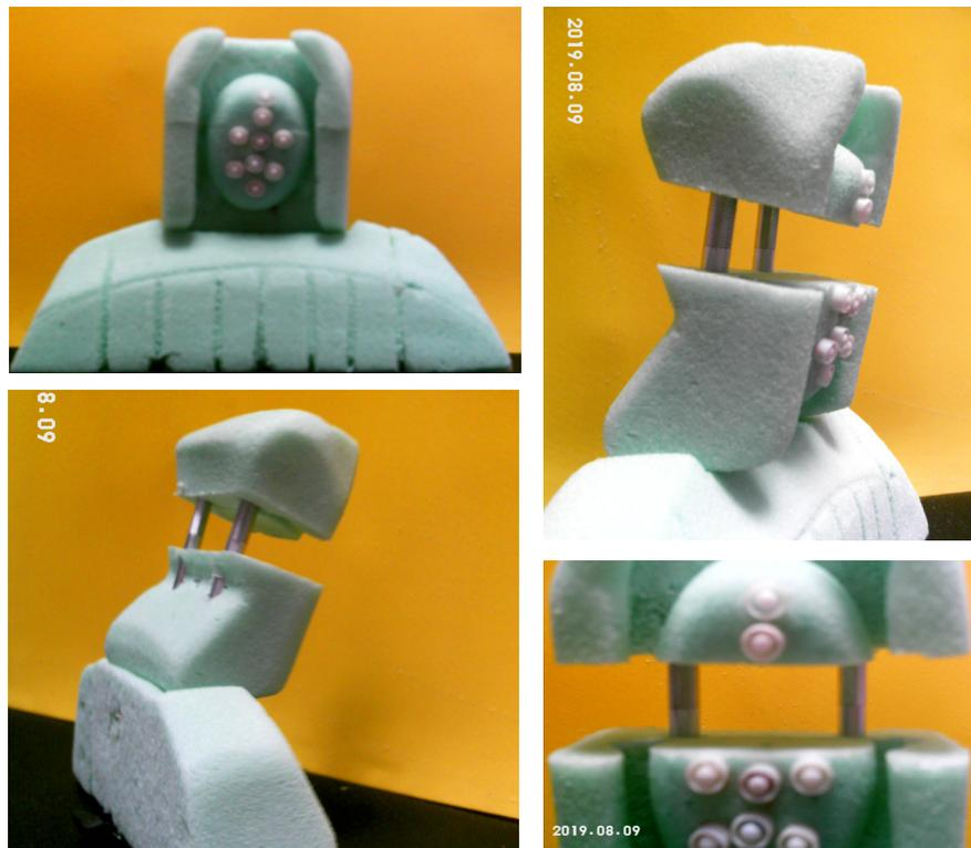
**Fig. 5.1** Vista frontal y reposacabezas desplegado.
