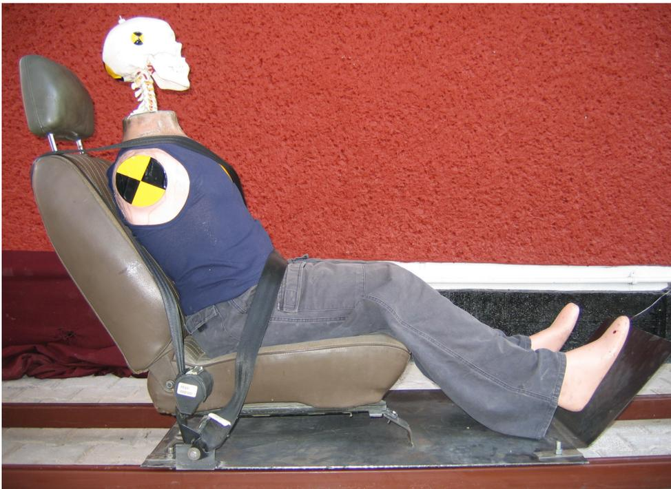
**Fig. 3.21** Trineo de deceleración con todos los elementos que lo conforman
