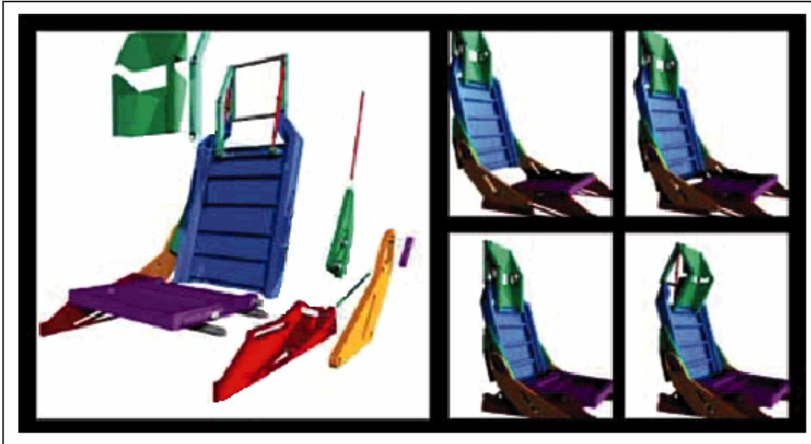
**Fig. 2.11** Mecanismos de ajuste automático del asiento (Centro Zaragoza 2000)
