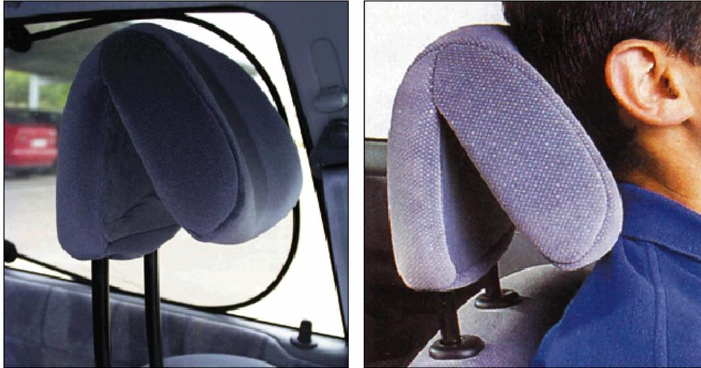
**Fig. 2.4** El diseño empleado por Renault ajusta al perfil del ocupante (Centro Zaragoza 2000)
