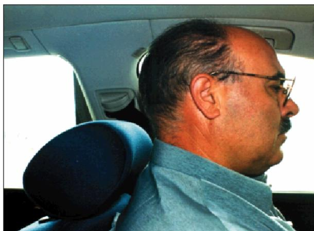
**Fig. 1.14** Reposacabezas demasiado bajo
