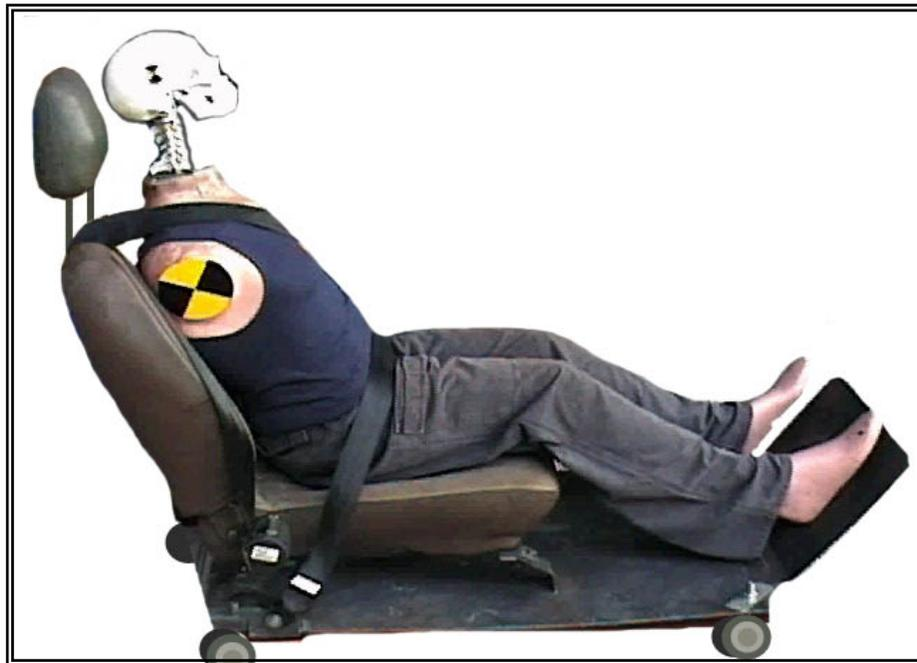
**Fig. 3.12** Montaje del trineo con el dummy
