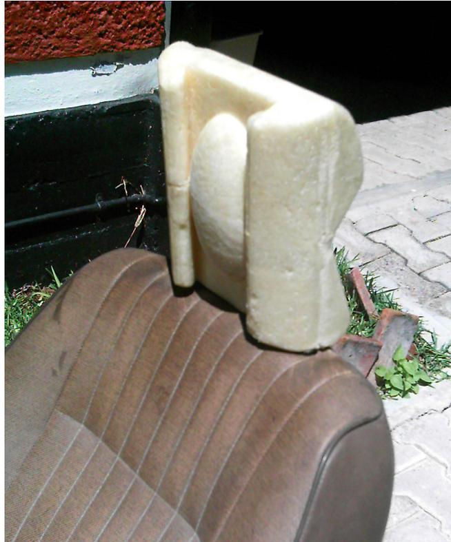
**Fig. 5.19** Prototipo volumétrico con inclinación con respecto al respaldo
