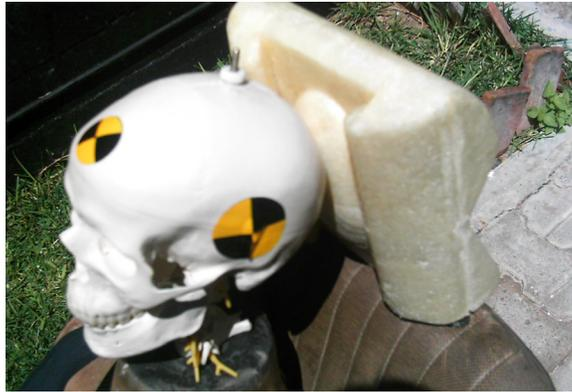
**Fig. 5.14** Montaje del prototipo volumétrico con respecto a un dummy de percentil 50
