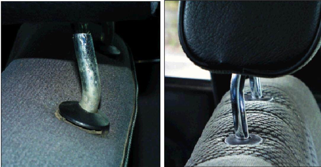
**Fig. 1.11** Distintos modelos de barras de anclaje con una cierta inclinación (Centro Zaragoza 2000)
