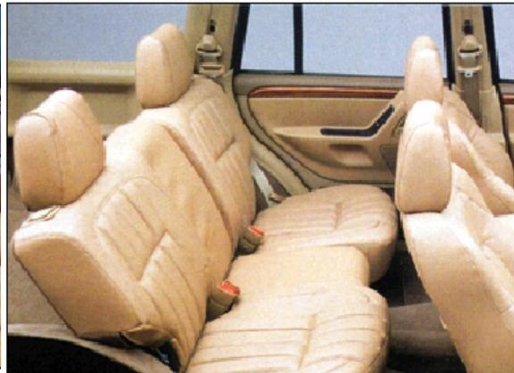
**Fig. 1.18** El reposacabezas compensa la inclinación típica del respaldo de 20-25 grados
