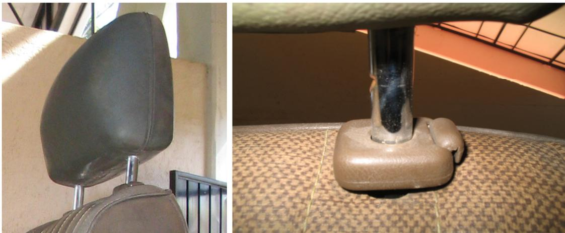
**Fig. 3.3** Izda. Reposacabezas del asiento, dcha. Barras de anclaje y pestaña de sujeción
