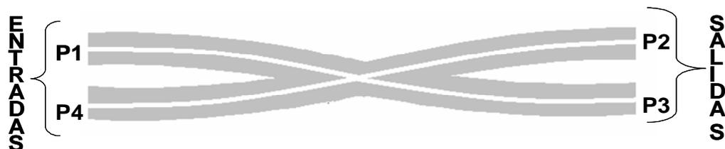
Figura 3.15. Configuración de los puertos del acoplador direccional de la empresa Canstar.
