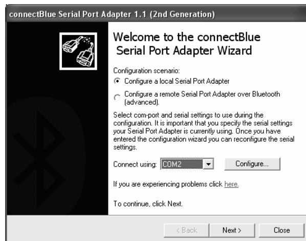
Figura A.7. Configuración del puerto serie COM.
