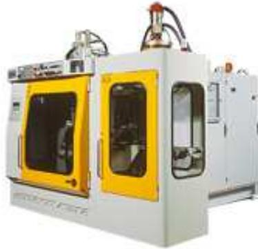
**FIG. 84 MÁQUINA DE EXTRUSIÓN SOPLO DE UNA ESTACIÓN**
