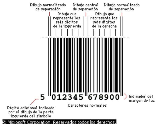
**FIG. 120 PARTES QUE CONFORMAN UN CÓDIGO DE BARRAS**
