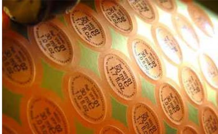
FIG. 138 EJEMPLO DE IMPRESIÓN POR SERIGRAFÍA
