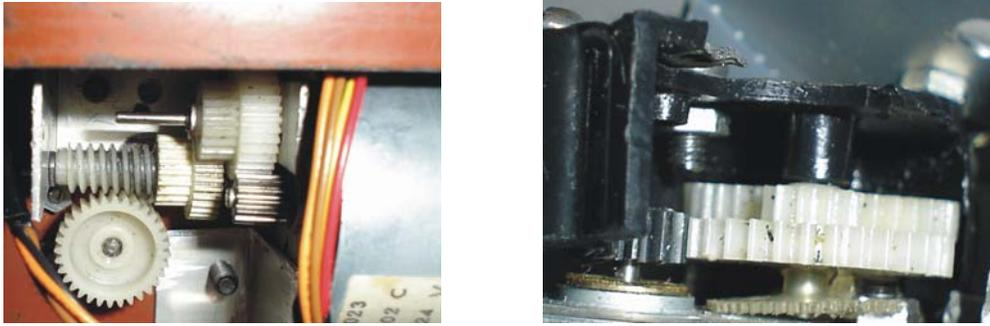
Figura 4.8. Engranaje Pan y Tilt.
