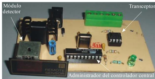
Figura 4.4. Prototipo del controlador central.
