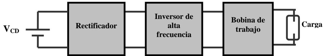
**Figura 2.17** Diagrama a bloques de una cocina de inducción
