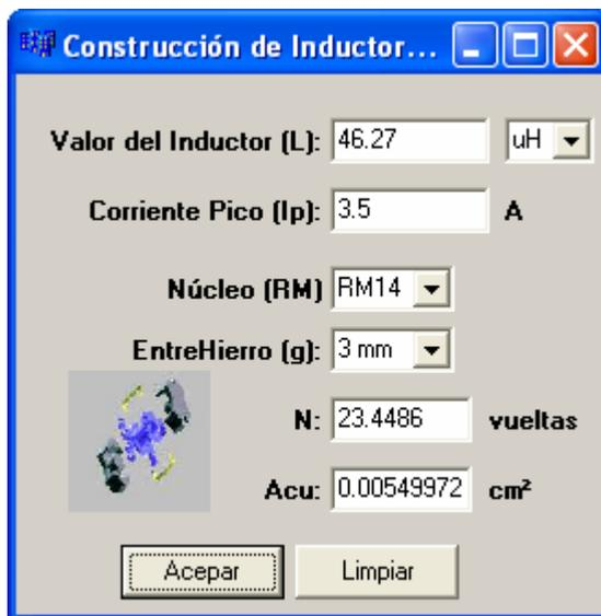
**Figura 4.3** Programa de cómputo para el diseño de inductores
