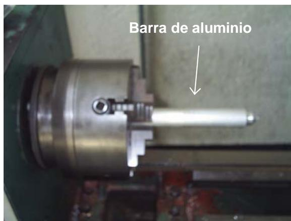
**Figura 3.6.** Centrado de la barra en el torno.
