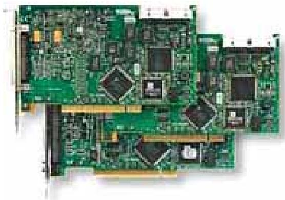
**Figura 2.18.** Fotografía de la tarjeta PCI-6024E.
