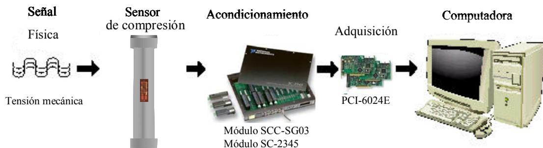
**Figura 2.1.** Diagrama a bloques para mediciones de tensión con galgas extensiométricas.
