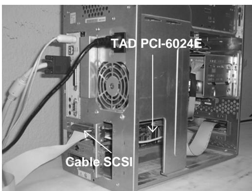
**Figura 4.9.** Conexión de la TAD PCI-6024E a la PC Compaq Presario.
