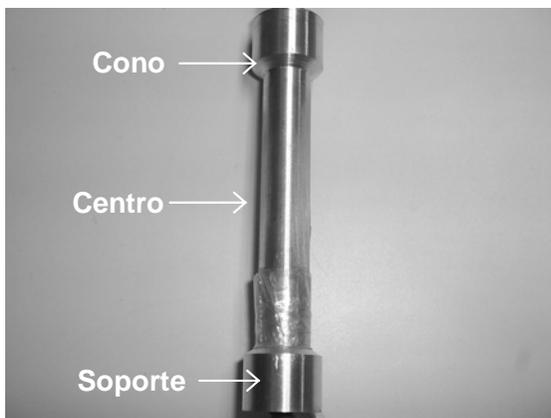
**Figura 3.12.** Columna circular manufacturada.
