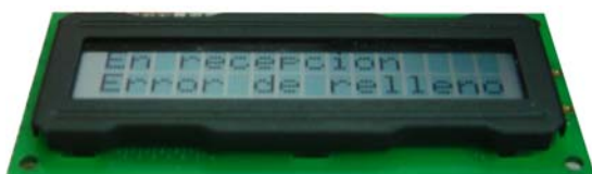
Figura 4.15. Señalización de errores en el bus CAN.
