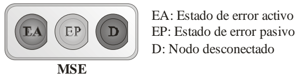
Figura A.4. Módulo MSE para señalización de estados de error del SeeCAN.
