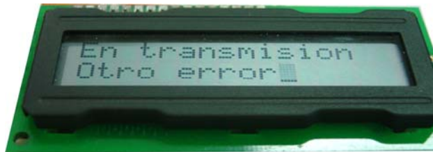
Figura A.5. Señalización de errores mediante el LCD.
