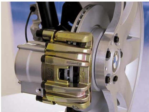
Figura 1.5. Sistema brake-by-wire del BMW Z22.
