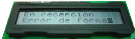
Figura 4.14. Señalización de estado de error activo y de error pasivo en el SeeCAN.
