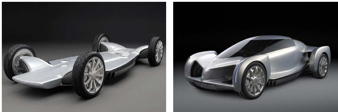
Figura 1.6. Detalles de diseño del automóvil Autonomy de GM.
