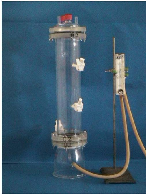
**Foto 20.** Reactor armado y unido al rotámetro.
