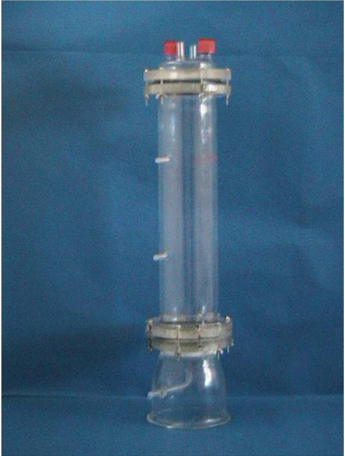
**Foto 1.** Columna de burbujeo armada con las bridas.
