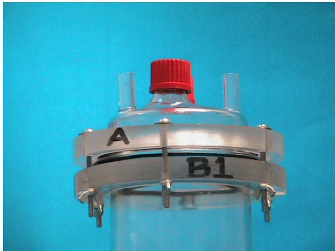
**Foto 14.** Unión y ajuste de bridas A y B.
