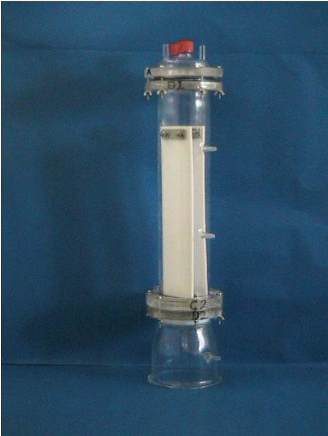
**Foto 2.** Biorreactor *airlift* con los *baffles* de teflón.
