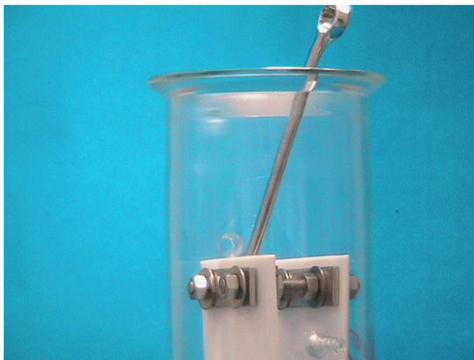
**Foto 27.** Ajuste de los *baffles* en el reactor.
