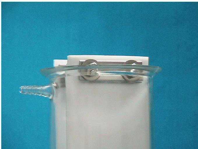
**Foto 26.** Saliente de los *baffles* en la parte inferior del reactor.
