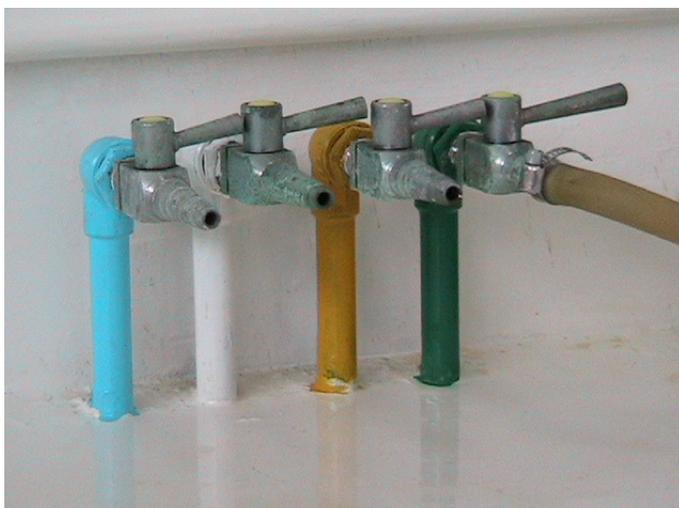
Foto 18. Manguera inferior del rotámetro conectada a la toma de aire del laboratorio.
