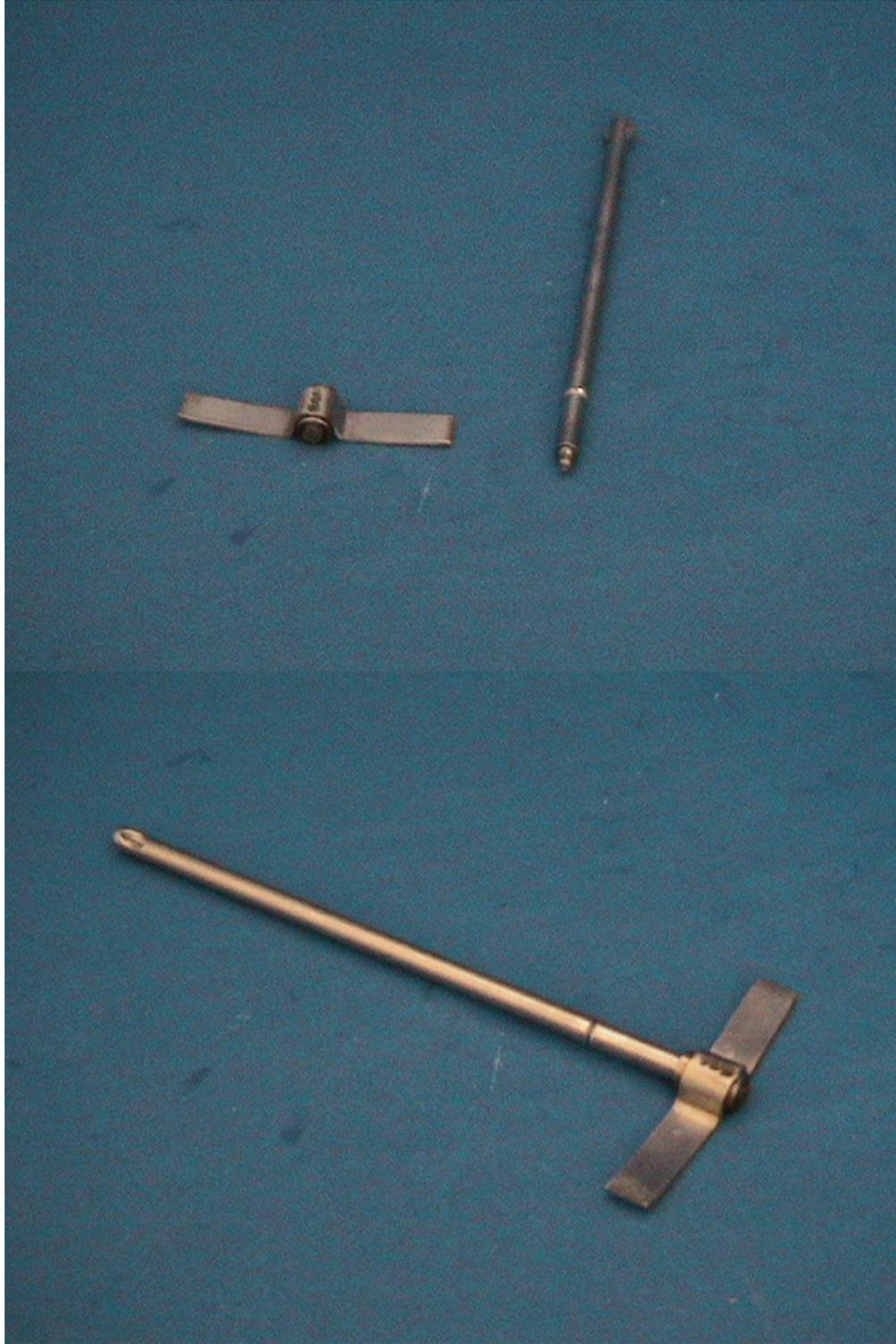
**Foto 3.** Agitador de paleta para la configuración RAM.
