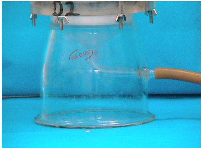
Foto 16. Introducción de la manguera de aire en el reactor.
