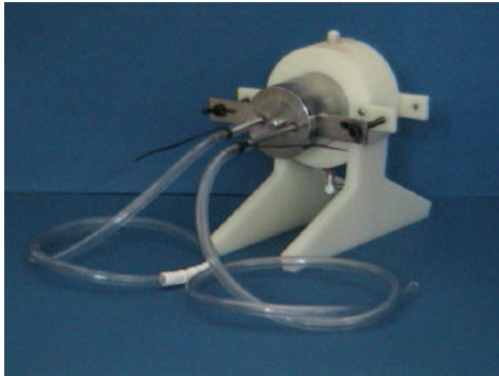
Foto. 5. Electrodo con sistema de enfriamiento.
