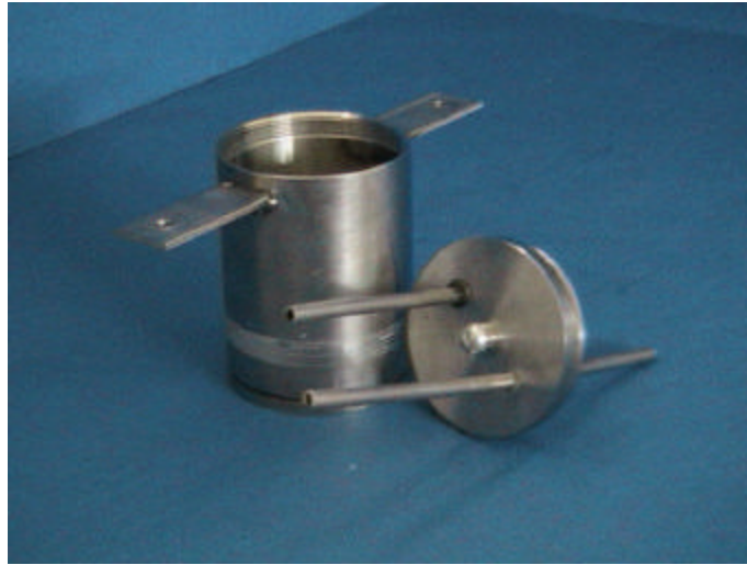
Foto. 2. Cuerpo y tapa del electrodo de acero inoxidable.
