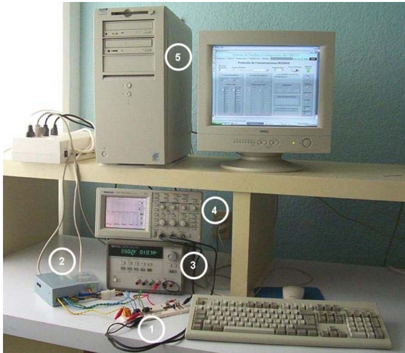
Figura 5.3. Instalación del sistema para las pruebas de laboratorio usando el puerto RS-232.
