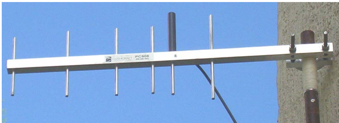
Figura B.8. Antena empleada para el enlace entre los radio-módems.
