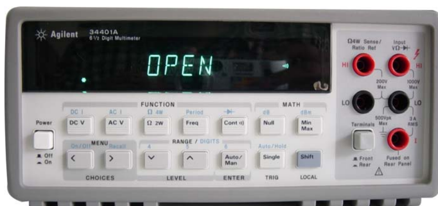
Figura 3.10. Multímetro modelo 34401A de la firma Agilent Technologies.
