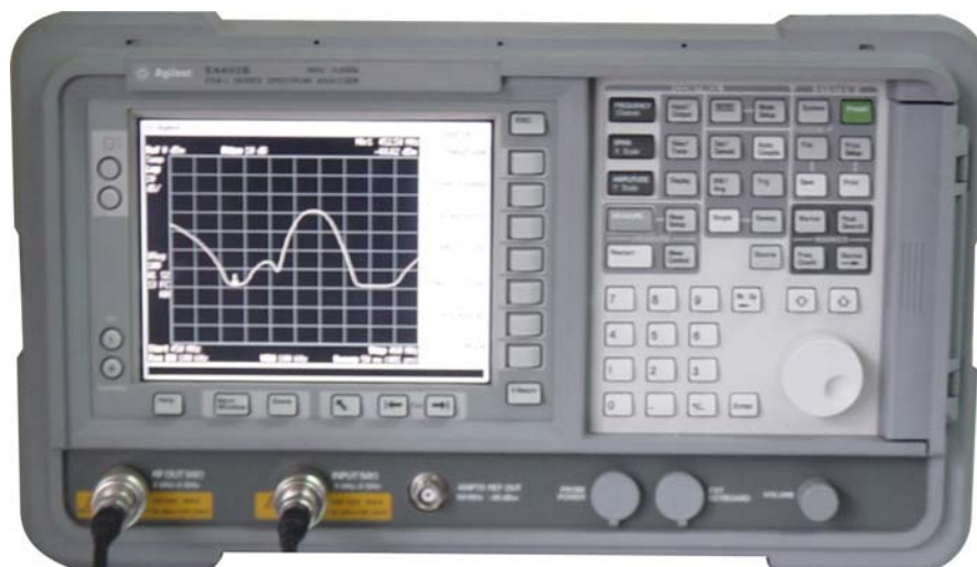
Figura 3.12. Analizador de espectros modelo E4403B de la firma Agilent Technologies.
