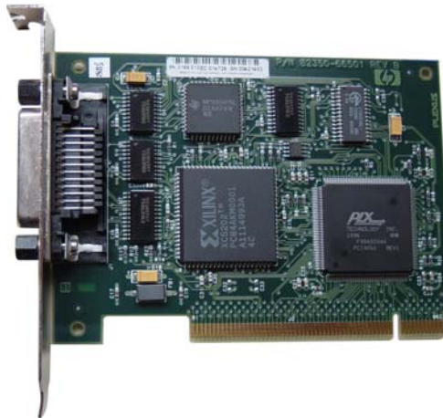
Figura 3.7. Tarjeta de interfaz GPIB modelo 82078A/82350A de la marca Agilent Technologies.
