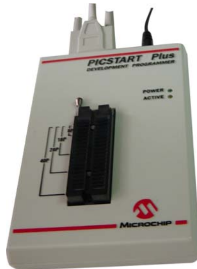
Figura 3.13. Programador de microcontroladores para familia Microchip.
