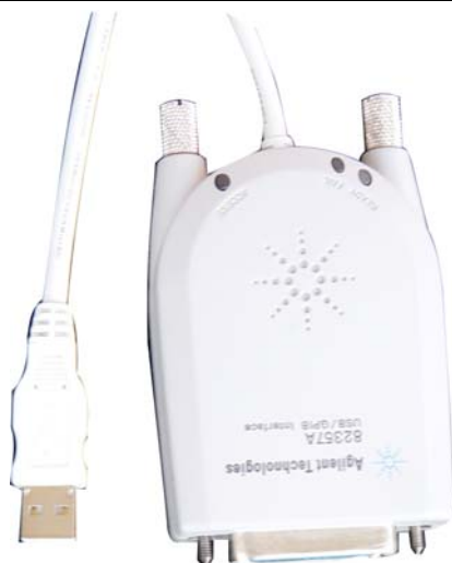
Figura 3.16. Interfaz USB/GPIB modelo 82357A de la firma Agilent Technologies.
