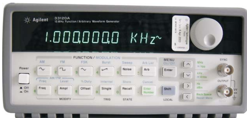
Figura 3.9. Generador de señales modelo 33120A de la firma Agilent Technologies.
