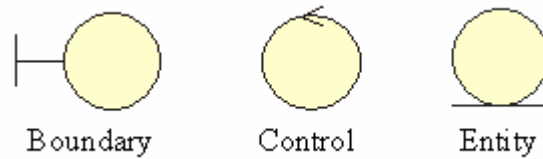
Fig. 5.6: Iconos de UML para representar los estereotipos de clases
