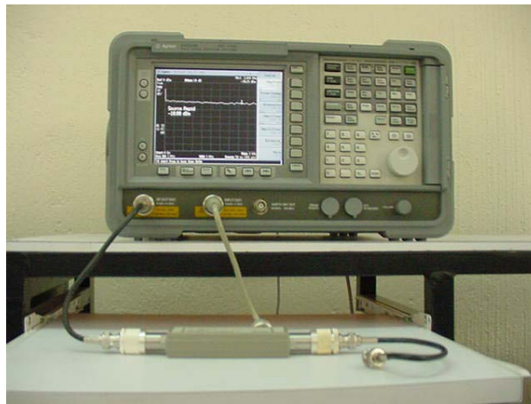
Figura 3.3 Conexión para el ajuste para S_{11} y S_{22} .
