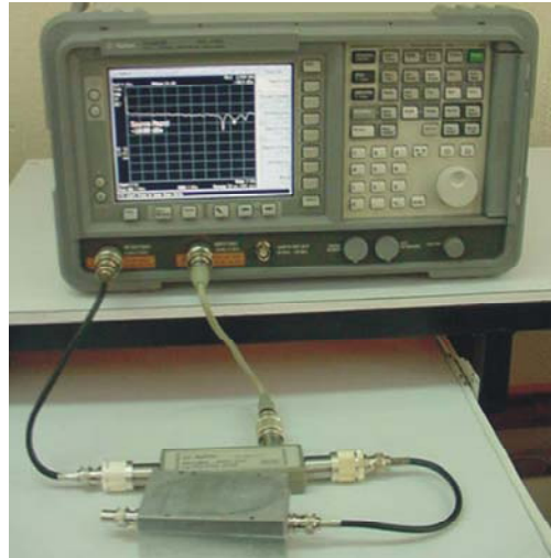
Figura 3.1 Montaje para la medición de los parámetros S_{11} y S_{22} .
