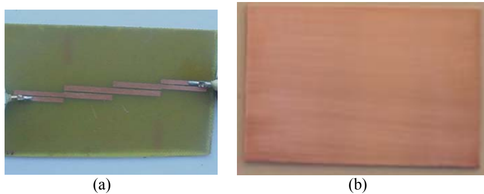
Figura 2.9 (a) Vista superior del filtro (líneas acopladas). (b) Vista posterior del filtro (plano de tierra)
