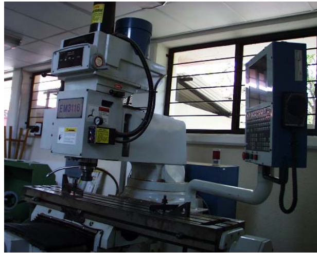
Figura 2.11 Fresadora CNC modelo EM3116 de la firma Dyna Mechatronics Inc.
