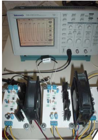
Figura 4.12 Medición del voltaje RMS para frecuencias ultrasónicas.
