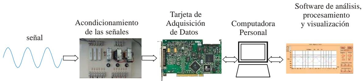
**Figura 1.22** Componentes de un Instrumento Virtual.
