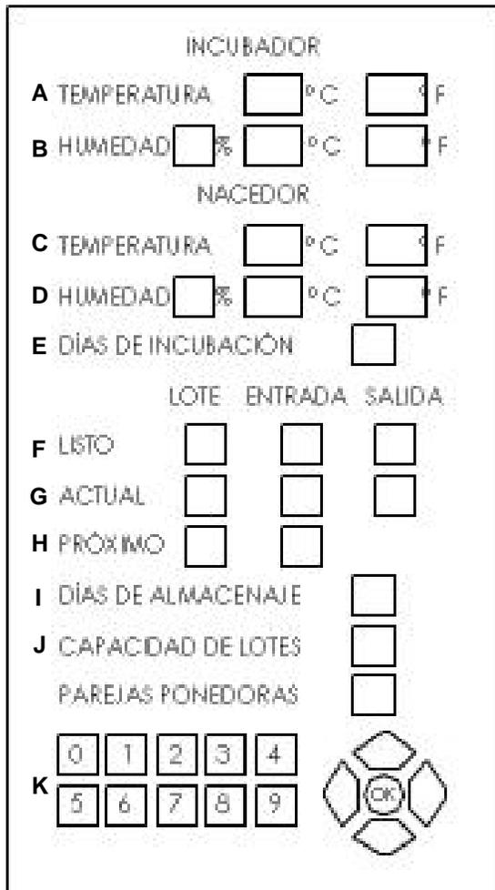
**Figura 3.8** Tablero de Información Constante, Programación y Control Digital
