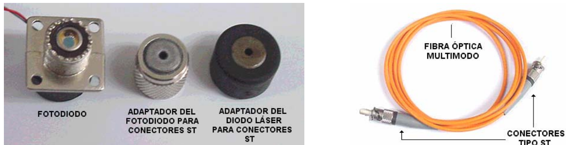
Figura 5.17. Componentes utilizados en las pruebas del subsistema de prueba de conectores.
