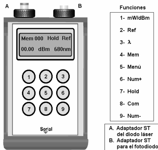
Figura 3.14. Distribución del menú en el teclado y formato de visualización de los resultados en el LCD
