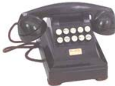
Figura 5. Prototipo de teléfono equipado con botones para marcado por tonos
