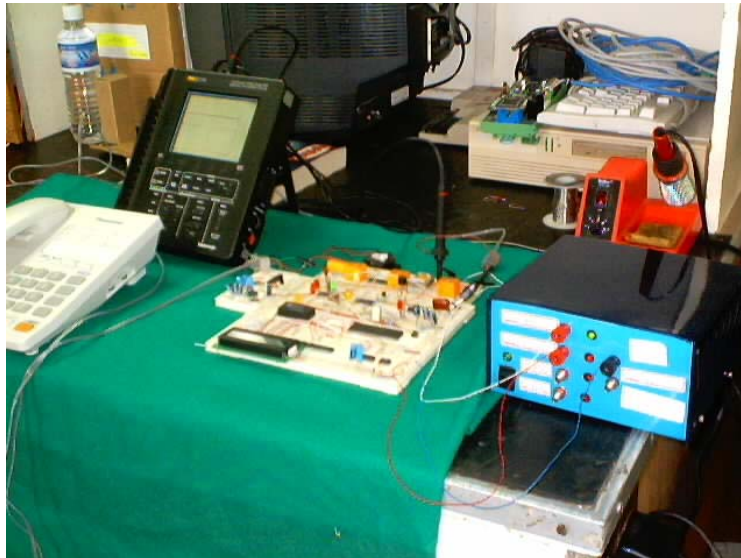
Figura 49. Equipo utilizado para monitorear las señales de la línea telefónica
