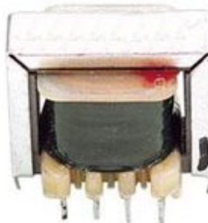
Figura 28. Transformador de acoplo de la línea telefónica
