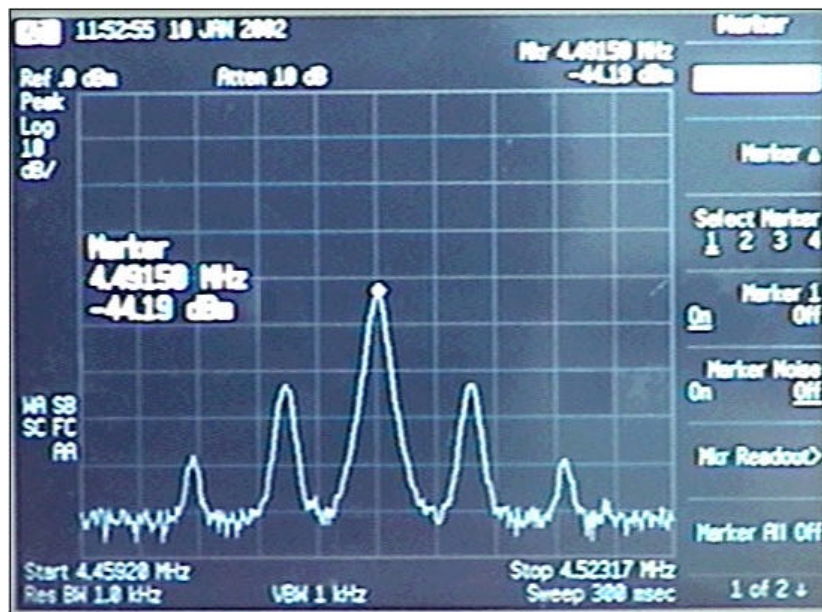
Fig. 3.20. Portadora de audio modulada por un tono de 10 KHz.
