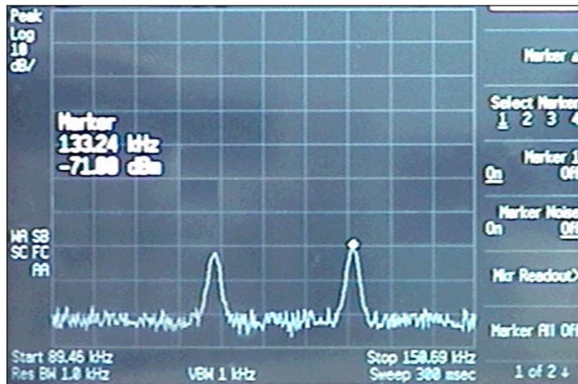
Fig. 3.9. Espectro de la señal de AM con portadora suprimida.
