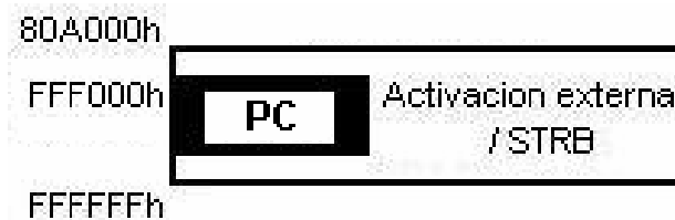
Figura 3.8 Rango de memoria de la señal /STRB
