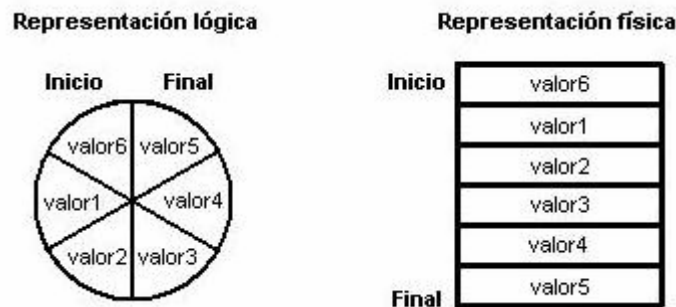
Figura 3.20b Almacenando datos de entrada x[n] a ser filtrados
