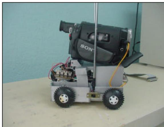
**Figura 5.3.** Móvil con videocámara.
