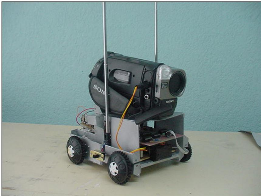
**Figura 3.10. Colocación de la cámara de video en el móvil.**
