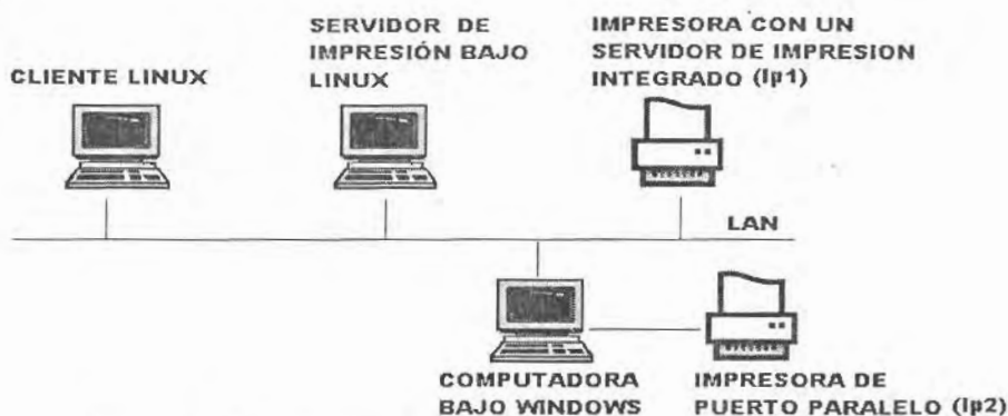
Figura 4.4. Infraestructura de cómputo que incluye un servidor de impresión
