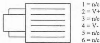
Fig. 2.5 Conector RJ-11. "Filamentos apuntando hacia el lector".
