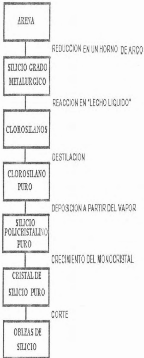
Fig. 1 Proceso de obtención del Silicio puro de grado semiconductor.
