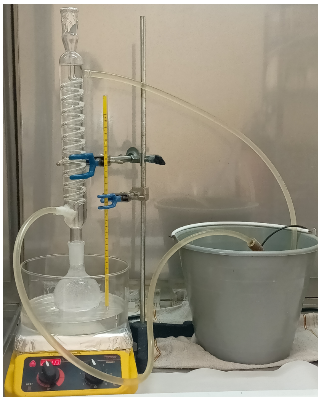
Figura 3.3: Estructura para la síntesis de la muestra de ZnO.
