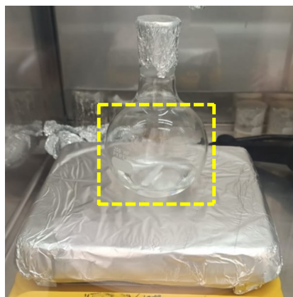
Figura 3.5: Apariencia resultante de la solución final de la síntesis de ZnO.
