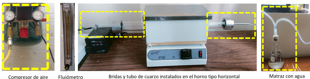
Figura 3.11: Conjunto empleado para realizar el tratamiento térmico
