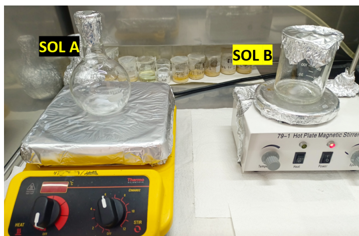
Figura 3.4: Solución A: con los reactivos 1-propanol y glicerol, solución B: con los reactivos 1-propanol, etilenglicol y trietilamina.
