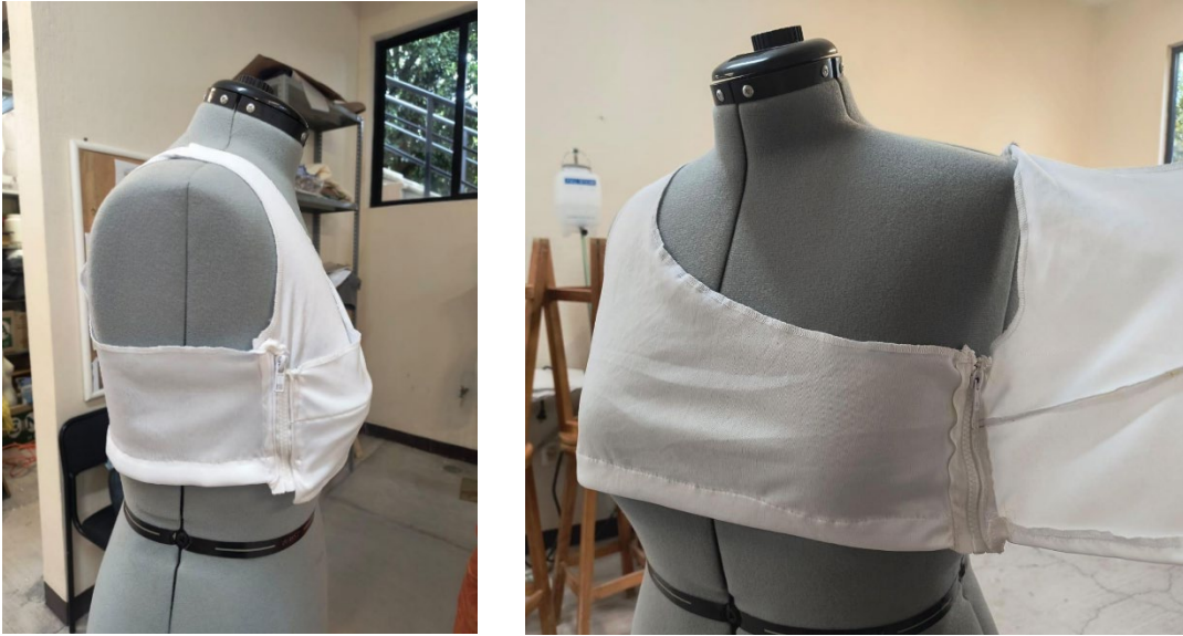
Figura 78. Colocación de cierre en los costados
