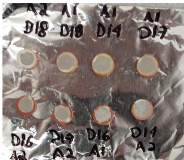
Figura 31. Formación de electrodos de Ag sobre los substratos recubiertos con Hematita.
