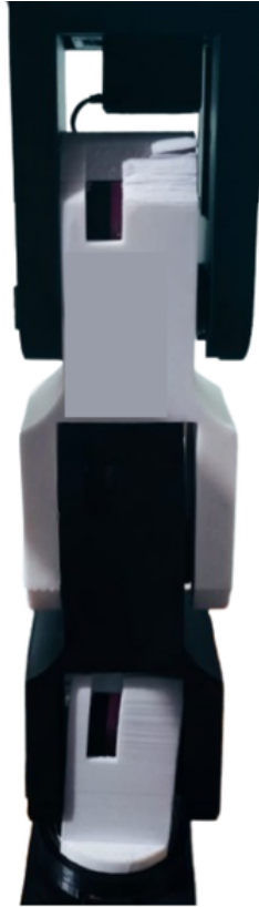
Figura 3.21: Configuración de la integración de eslabones 2, 3 y 4
