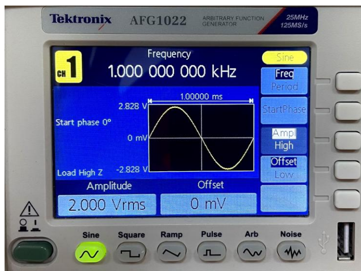
Figura 5.9. Señal de entrada con frecuencia de 1 kHz y amplitud de 2 V RMS .
