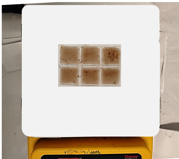
Figura 5.2: Sustratos de vidrio colocados en el centro de la placa calefactora, la dispersión empleada para realizar el depósito es con una concentración de 1.0 \text{mg/mL} . Sobre cada sustrato se depositaron 400 \mu\text{L} , con la parrilla apagada.
