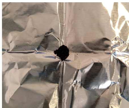
Figura 5.3: Polvo de óxido de grafeno reducido, material recuperado luego de raspar 6 películas de r-GO.
