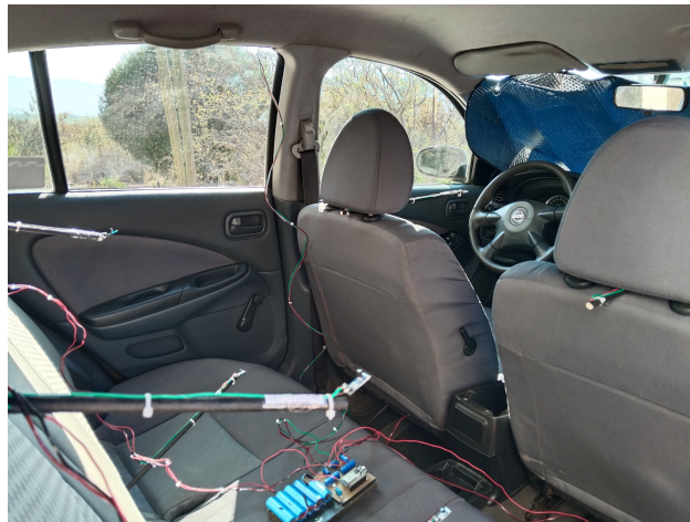
Figura 3.13: Sistema de medición de temperatura en funcionamiento.
