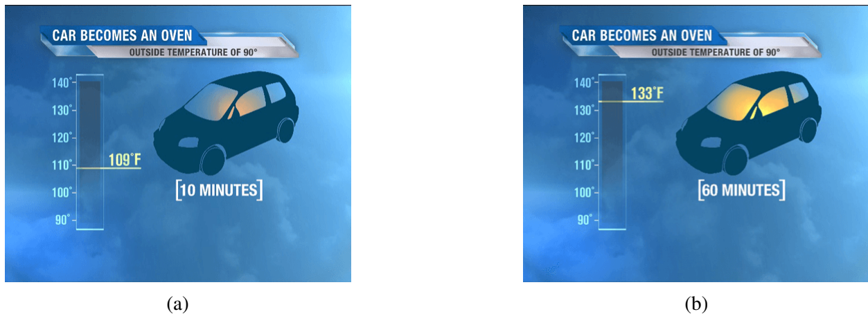
Figura 1.11: Incremento de la temperatura en la cabina de un vehículo [20], (a) temperatura de 42^{\circ}\text{C} después de 10 minutos y (b) temperatura de 56^{\circ}\text{C} después de 60 minutos.
