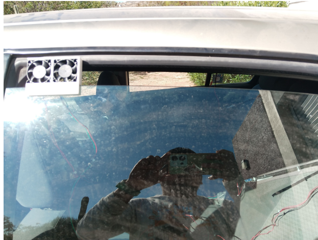
Figura 6.9: Ubicación de los ventiladores encargados de introducir aire del exterior.
