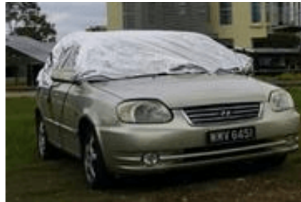
Figura 1.8: Cubierta reflectante solar de aluminio laminado de baja absorción solar [13].
