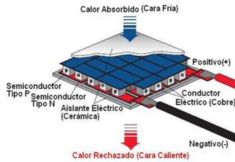
Figura 2.13: Esquema de la estructura interna de una celda Peltier [5].
