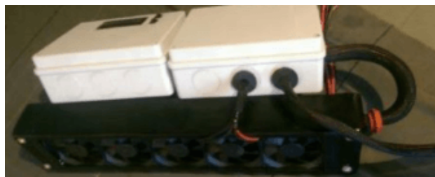
Figura 1.1: Sistema de climatización con celdas Peltier [2].
