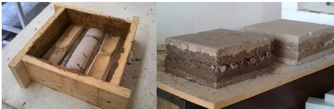
Figura 1.2 Probetas compuestas de bajereque.
