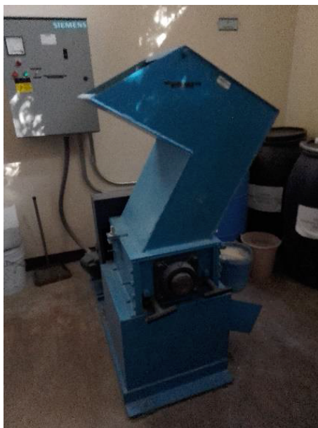
Figura 3.2 Triturador de polímeros rígidos del Laboratorio Minero-Metalúrgico.
