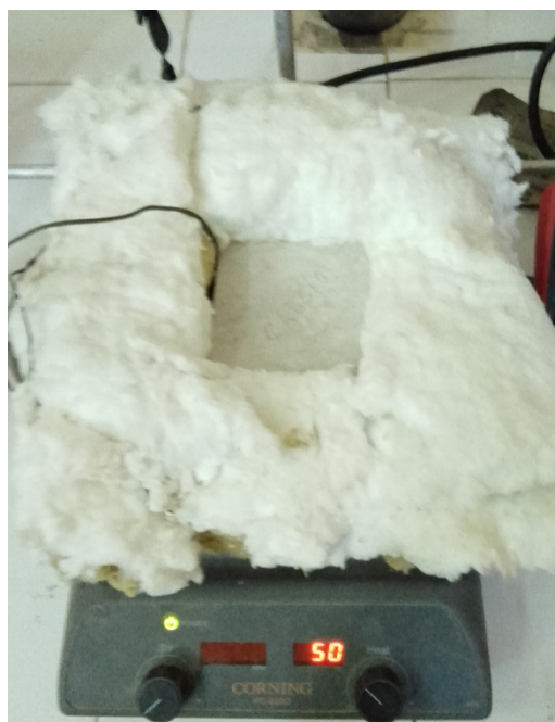
Figura 3.18 Sistema para determinar la conductividad de las probetas.
