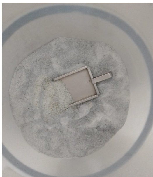
Figura 3.8 Partículas de vidrio obtenidas de la trituración.
