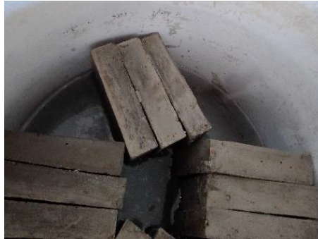
Figura 3.16 Cubeta con agua y probetas de cemento.
