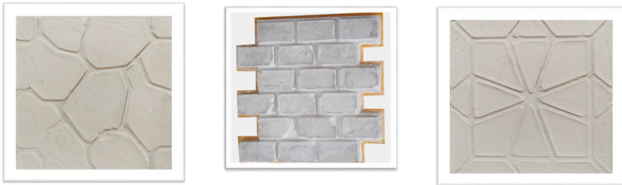
Figura 4.7 Piezas terminadas con un recubrimiento de pintura vinílica.
