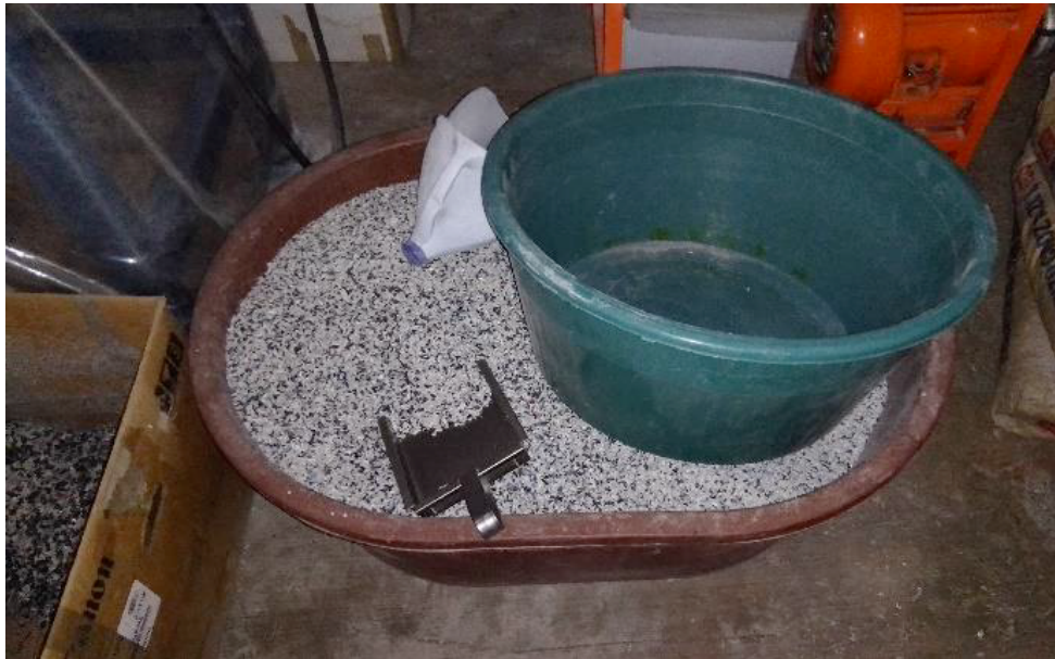
Figura 3.3 Partículas de ABS obtenidas de la trituración.
