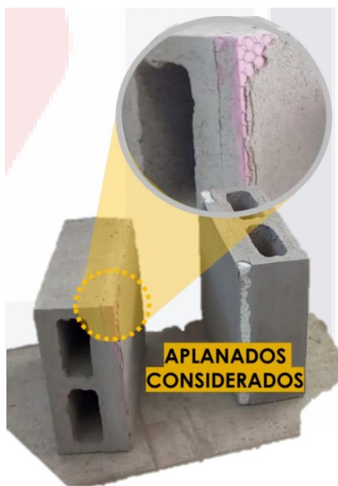
Figura 1.1 Muestras de block con recubrimiento aplicado.
