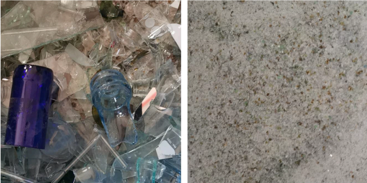
Figura 2.5 Desecho de vidrio para trituración y triturado.
