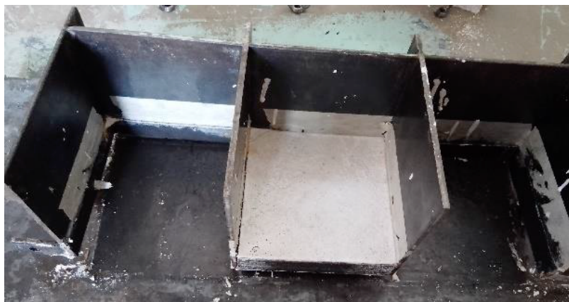
Figura 3.15 Molde para elaboración de probetas, donde las probetas son sacadas del recipiente.
