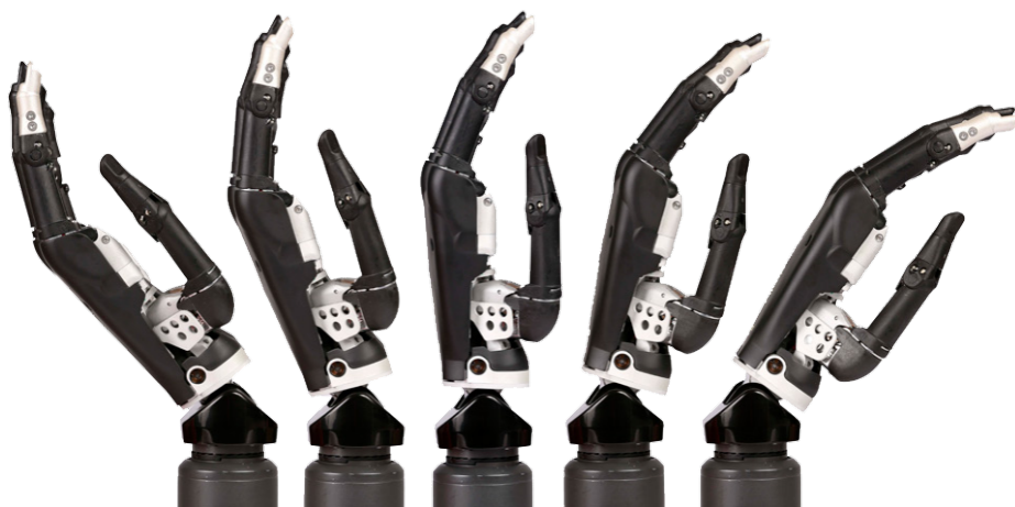
Figura 1.8: Movimientos de la muñeca de la prótesis i-Limb® Quantum [10].
