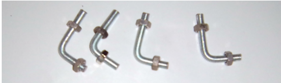
Figura 3.20: Varillas roscadas y dobladas para la construcción de los enlaces distales.
