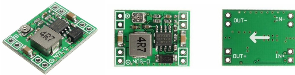
Figura 6.4: Convertidor de voltaje DC-DC Step-Down MP1584.
