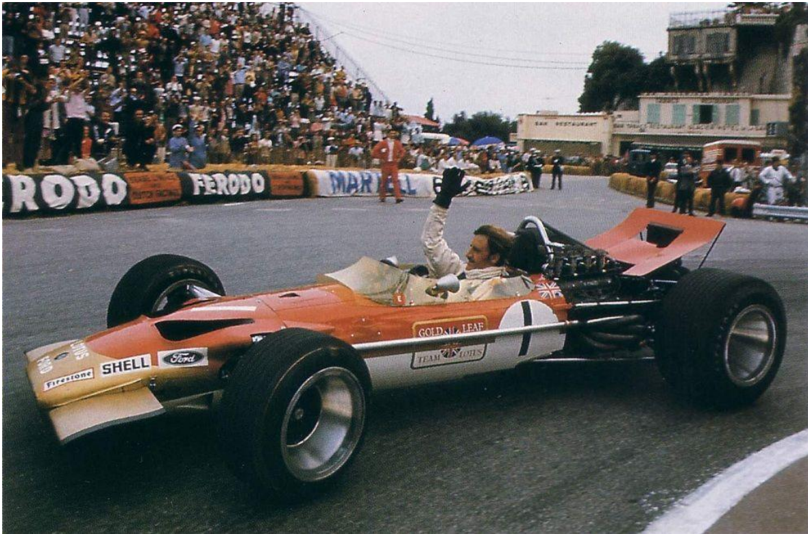
Figura 2. Implementación de los primeros alerones delanteros en Lotus 49B [13]
