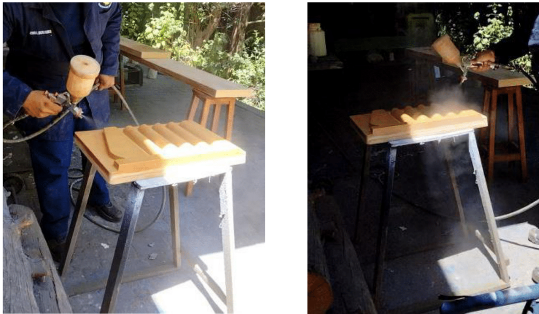
Figura 4. Aplicación del sellador de nitrocelulosa
