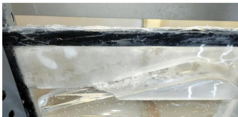
Figura 11. Aplicación de una capa uniforme de silicón en todo el contorno del tanque, evitando excesos. Tiempo de secado: 24 horas.
