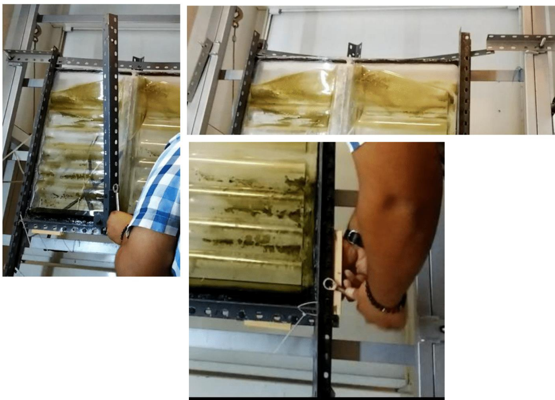
Figura 2. Desmontaje del contenedor del microalgas.
