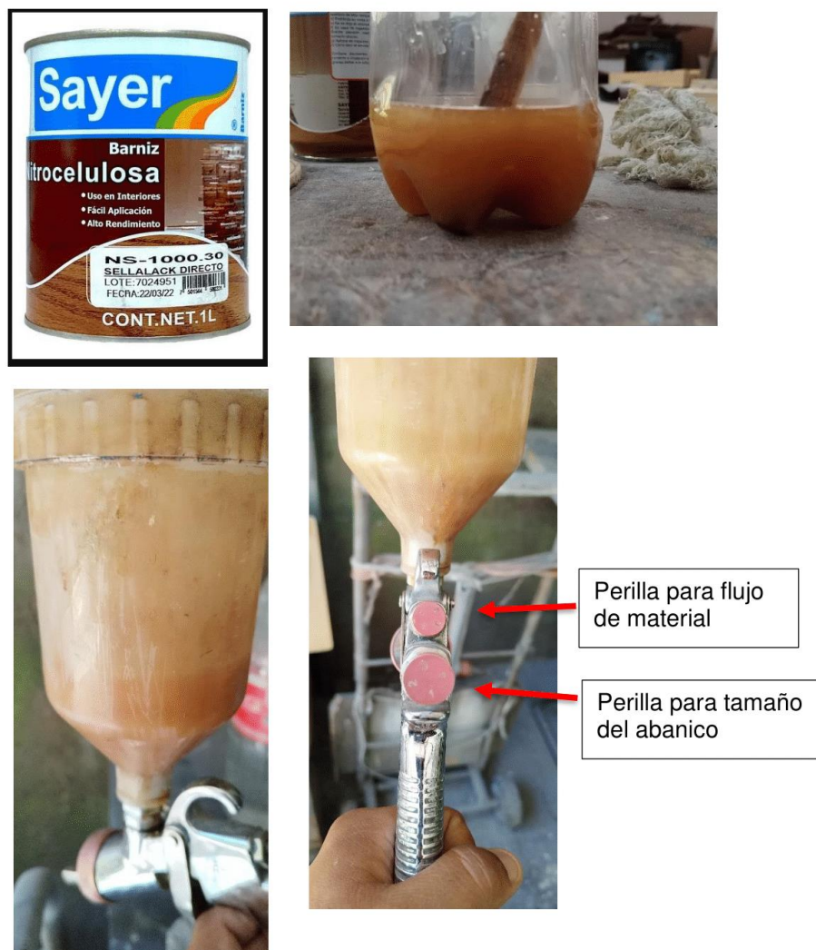
Figura 3. Llenado del sellador de nitrocelulosa en el depósito de la pistola de gravedad.
