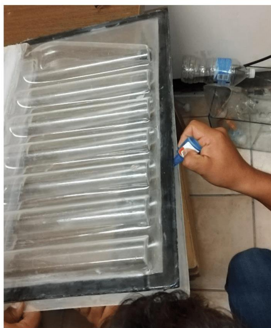
Figura 9. Aplicación de adhesivo en líneas más largas para fijar la segunda placa, facilitando el ensamblaje.
