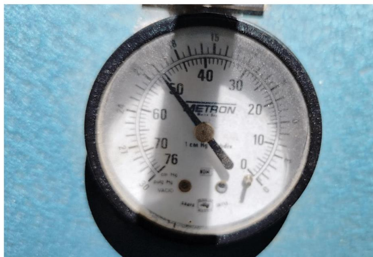
Figura 5. Manómetro de la termoformadora.
