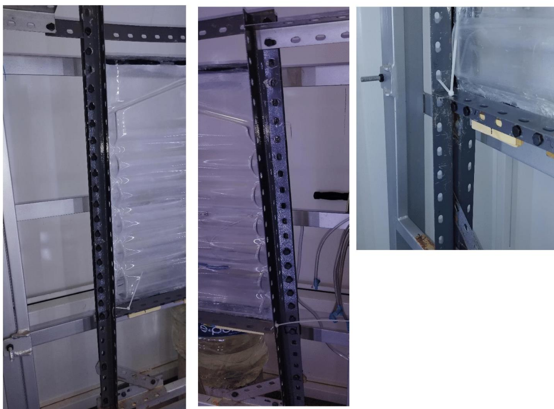
Figura 13. Fijación de los perfiles laterales y superiores con tornillos y bridas de plástico para mayor estabilidad en la estructura del FBR.
