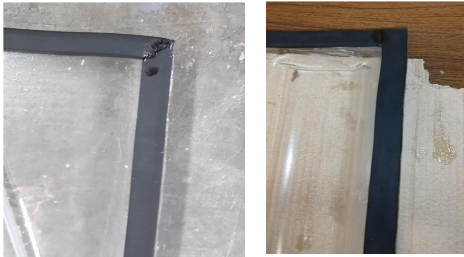
Figura 19. Soleras de hule espuma (de etileno-propileno) adheridas a las placas de acrílico.
