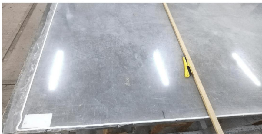
Figura 2. Medición y corte de las placas de acrílico.
