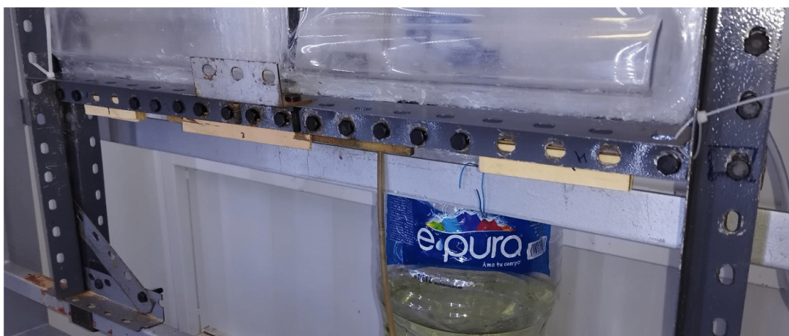
Figura 3. Retiro de los tornillos del perfil base del tanque.
