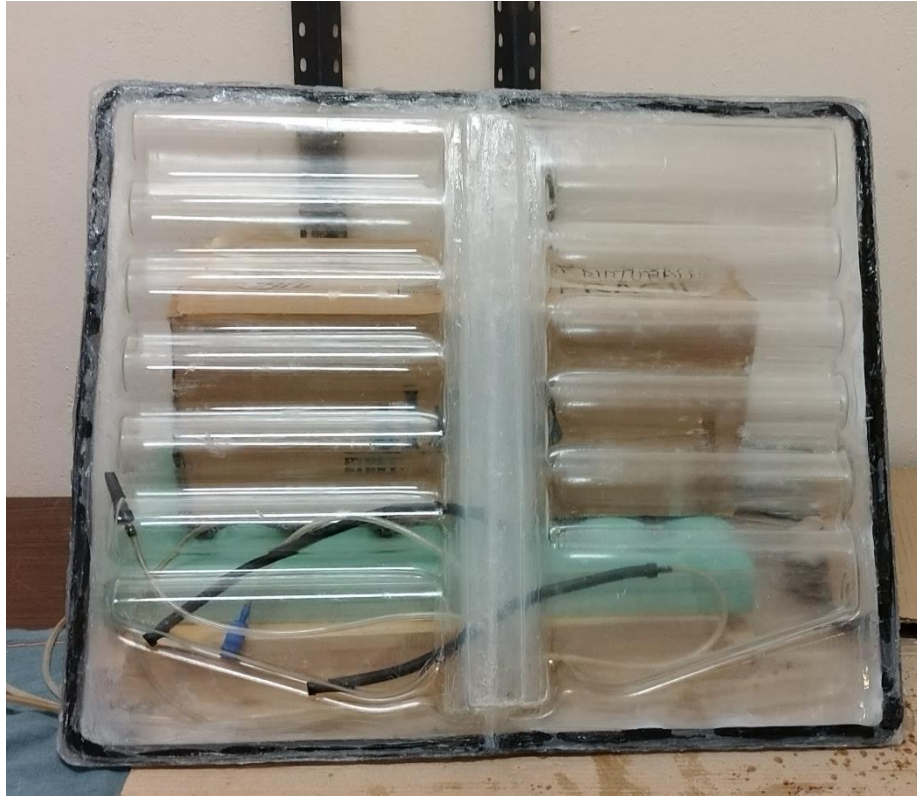
Figura 14. Contenedor de microalgas del FBR con difusores de aire.
