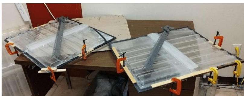
Figura 10. Fijación de la segunda placa con tiras de madera y prensas “C”, evitando exceso de presión para prevenir daños o fugas. Tiempo de sujeción: 48 horas
