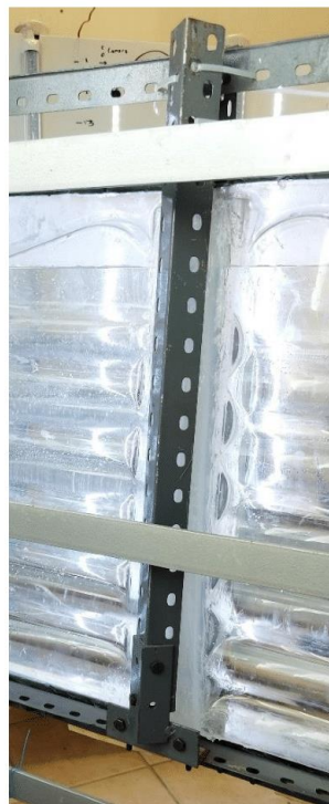
Figura 15. Fijación de los ejes centrales con tornillos y ajuste superior con cuatro bridas de plástico para mayor estabilidad.
