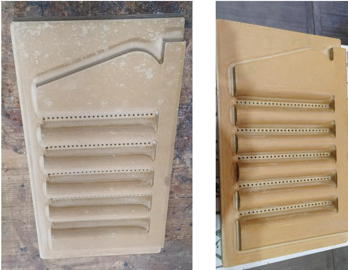
Figura 21. Molde de MDF empleado en el termoformado de placas de acrílico, antes y después del mantenimiento preventivo.
