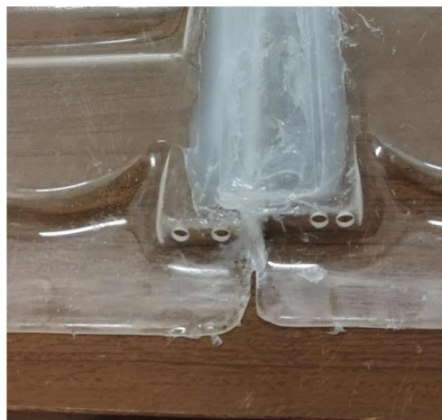
Figura 3. Identificar la posición de cada cara antes de unirlos es de suma importancia.
