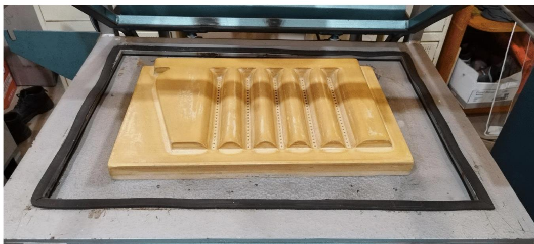
Figura 7. Colocación y centrado del molde en la termoformadora.
