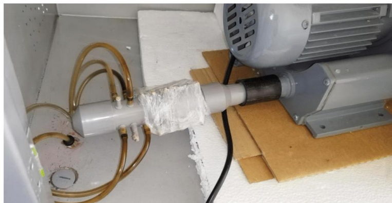
Figura 16. Conexión de mangueras a bomba de aire
