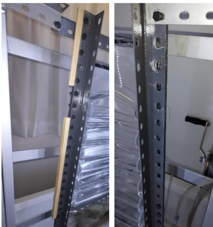
Figura 14. Uso de tiras de madera para estabilizar los perfiles laterales y evitar el desprendimiento del silicón. En algunos casos, el tamaño del tanque puede reducir la necesidad de atornillado completo.
