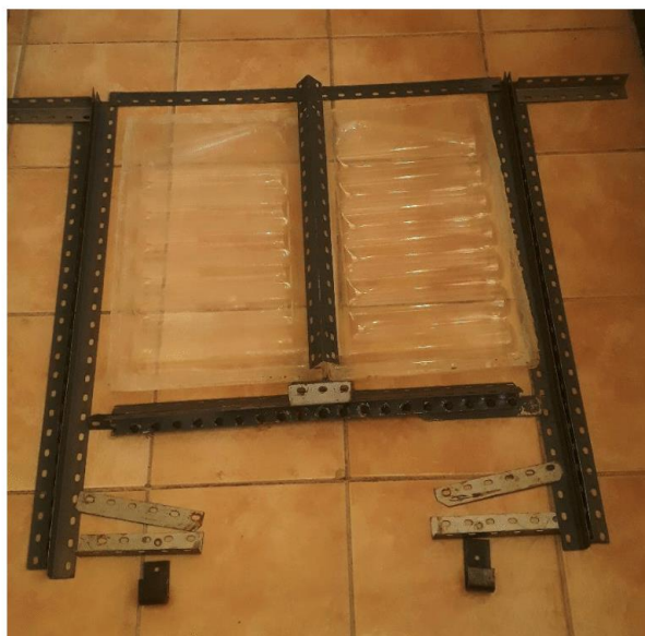
Figura 1. Esqueleto completo del FBR con sus soportes de perfiles metálicos.
