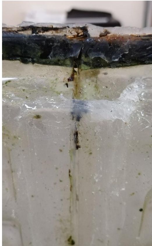
Figura 22. Acumulación de bioincrustaciones en la parte inferior del contenedor.
