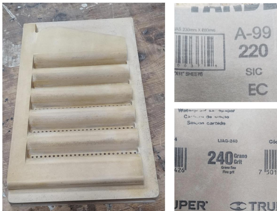
Figura 2. Lijado de los moldes
