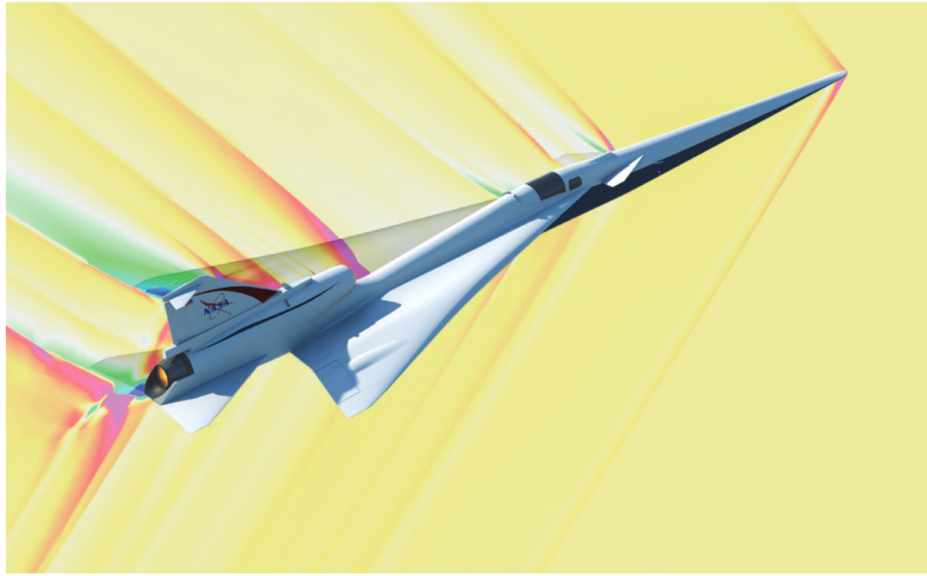
Figura 10: Esta simulación muestra cómo las ondas de choque del X-59 se dispersan al volar a velocidades supersónicas. A diferencia de los aviones convencionales, cuyas ondas se combinan en un estampido sónico, el diseño del X-59 evita esta convergencia, generando un estallido sónico mucho más suave [33].
