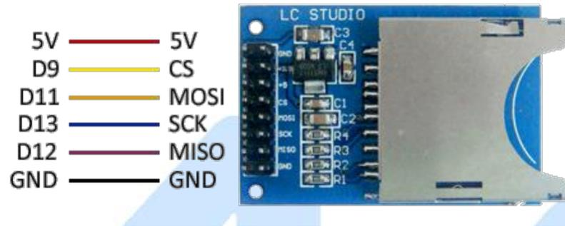
Figura 3.14: Diagrama de conexiones, Arduino UNO a módulo de lectura y escritura de tarjeta SD modelo OKY3001 [40].
