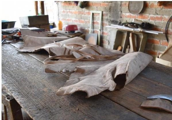
Para realizar las plantillas que formarán el huarache, sobre la piel se calca el par a partir de moldes previamente diseñados, ya que, por lo regular, se realizan pedidos de los mismos modelos.
