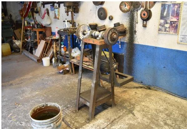
Las ruedas anteriores dan acabados mates al cuchillo. Gracias a un descubrimiento por la primera generación de artesanos de cuchillería, se logró tener un brillo tipo espejo con ayuda de ruedas de cartón.
