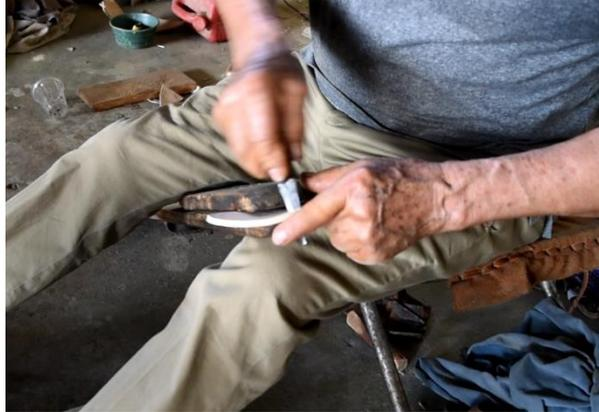
Para tener una forma perfecta en el huarache, se utilizan formas elaboradas a partir de madera tallada, estas pueden tener una abertura en la parte frontal para realizar diferentes cortes de calzado. Dichas formas pueden ser elaboradas por los mismos artesanos o adquiridas directamente desde fábricas especializadas.
