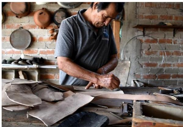
Después de realizar las piezas que formarán las plantillas se realizarán perforaciones para introducir las cintas cortadas previamente. El número y ubicación de estas dependerá del diseño a elaborar, la orientación que se requiera de las cintas, así como de la creatividad del artesano.
