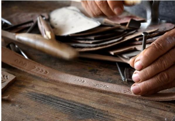
Para el resto de piezas a utilizar en el ensamble del huarache, debido a que se manejan en pares y los diseños son requeridos continuamente, se realizan de manera similar que las plantillas, por medio de moldes previamente realizados. Dichos moldes también incluyen el tamaño y posición de las ranuras necesarias. Finalmente, se ensamblan sobre las formas y se dejan secar.
