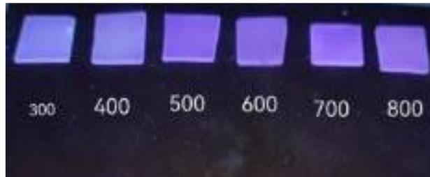
Figura 4.1 Películas fotoluminiscentes de  $\text{ZnZrO}_3$  excitadas bajo luz UV a 254 nm.
