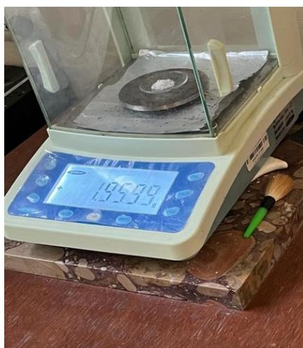
*Figura 3.5 Balanza analítica para el pesaje de reactivos*
