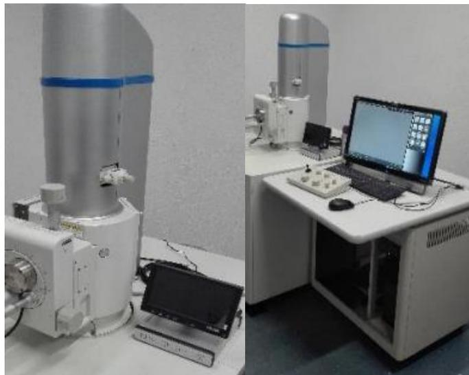
*Figura 3.16 Microscopio electrónico de Barrido equipado con EDS (Energy Dispersive System), JEOL JSM-6010PLUS/LA*
