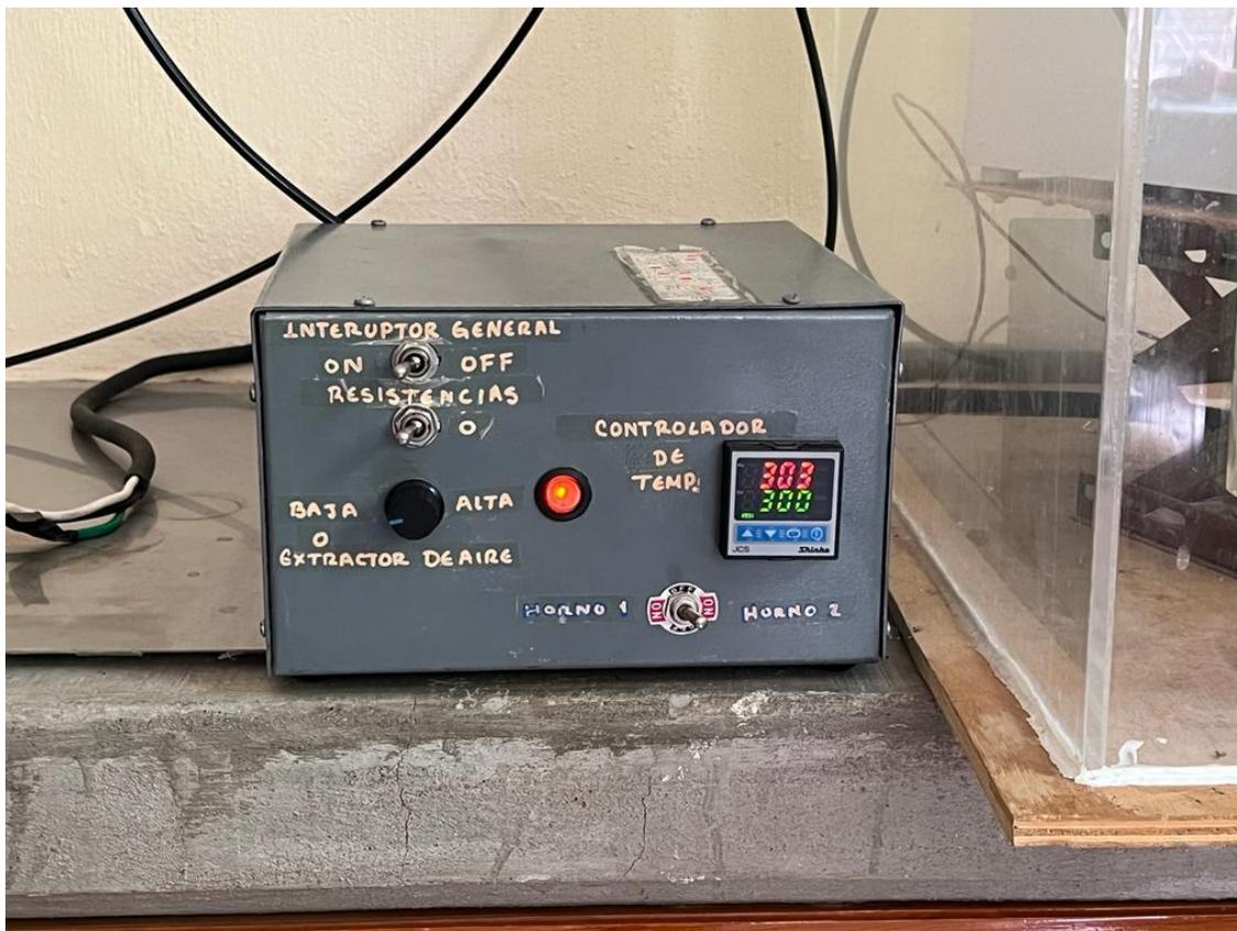
*Figura 3.13 controlador de temperatura*
