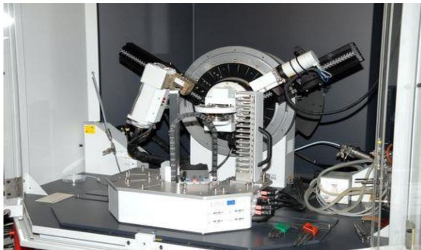
*Figura 2.9 Difractómetro empleado para la caracterización por DRX*
