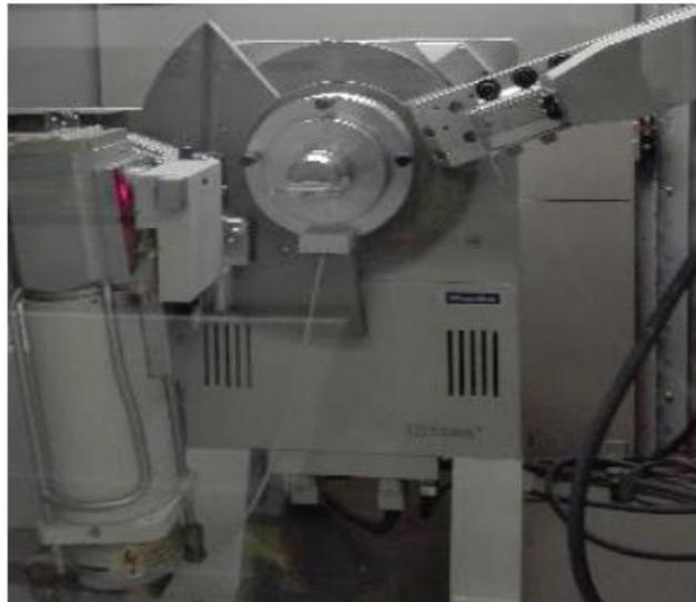
Figura 3.15 Difractómetro de haz rasante, Rigaku Dmax2100
