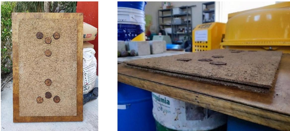
*Nota.* En la figura se observa parte del proceso del desmolde del panel y el machihembrado. Fuente: Propia (2024).
