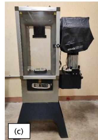
*Nota.* (a) Triturador Bio 100. (b) Horno de secado Binder. (c) Maquina a compresión PILOT COMPACT-Line de 1500 kN. Fuente: Propia (2022).
