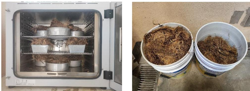
*Nota.* La figura muestra el proceso de secado y almacenamiento del bagazo de agave. Fuente: Propia (2022).
