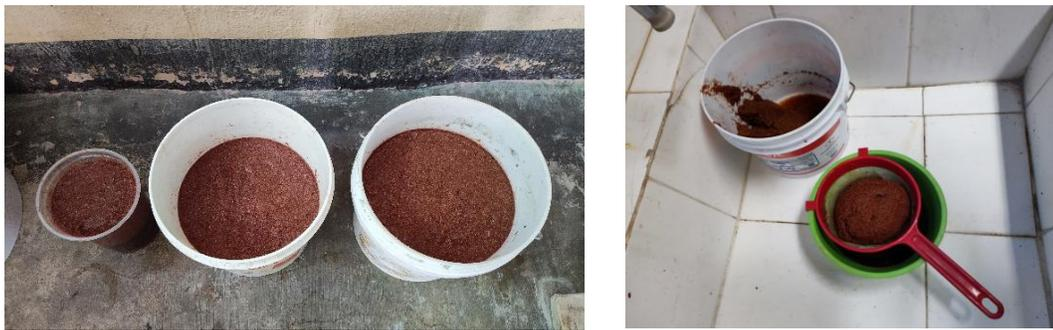
*Nota.* La figura muestra el proceso del reposo del PCC en agua y el proceso de escurrimiento del agua sobrante. Fuente: Propia (2023)
