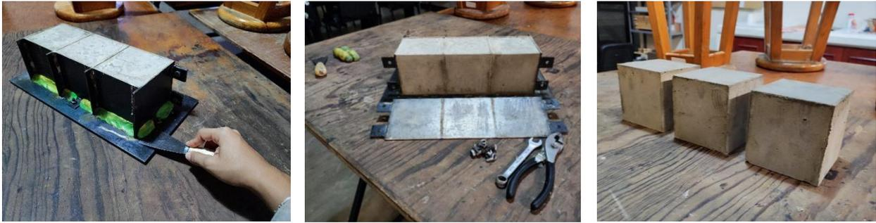
*Nota.* La figura muestra el proceso de desmolde de las probetas. Fuente: Propia (2023).
