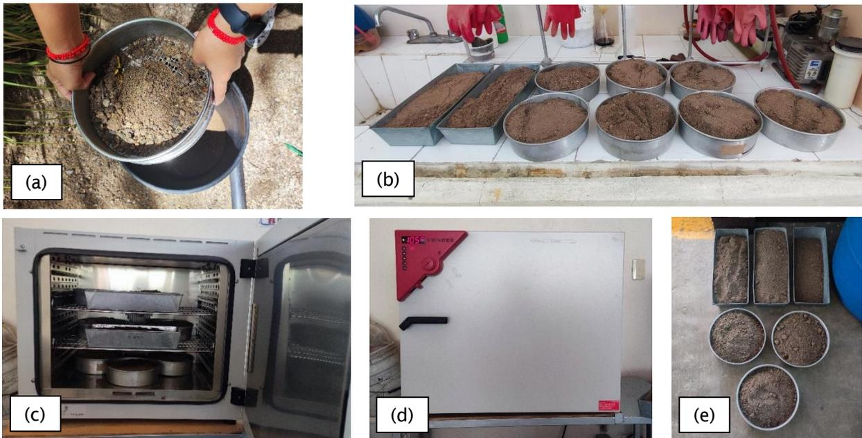
*Nota.* (a) Tamizado de arena. (b) Vaciado de arena a moldes. (c) Materia en horno. (d) Proceso de horneado/secado. (e) Materia en reposo. Fuente: Propia (2022).
