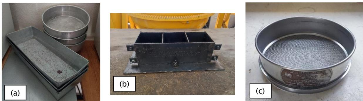
*Nota.* (a) Moldes para horno. (b) Molde para probetas. (c) Tamiz número 4 y16. Fuente: Propia (2022).
