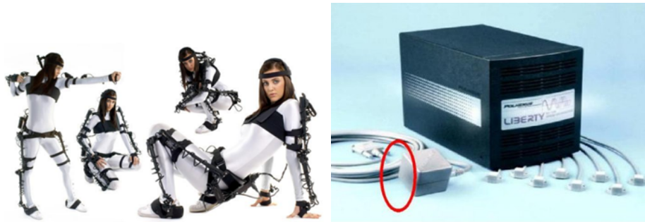
(a) Captura de movimiento mecánico. (b) captura de movimiento magnético.
