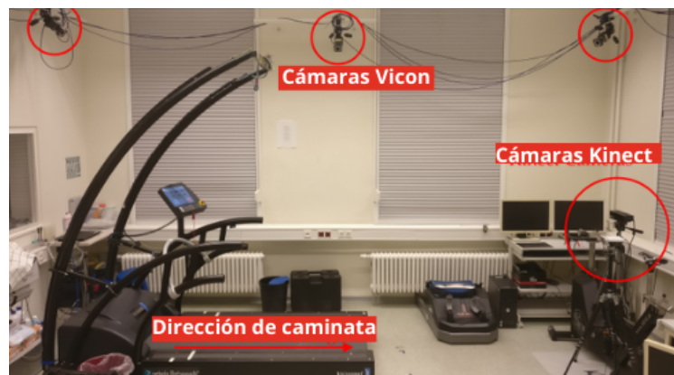
Figura 1.6: Montaje experimental en el laboratorio. Ambas cámaras Kinect se colocaron frente a la caminadora [15].
