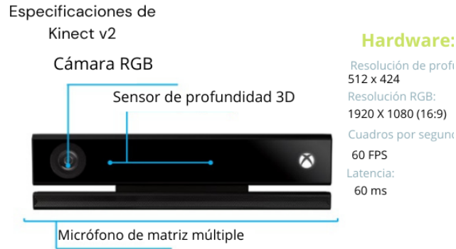
Figura 2.9: Visualización de los componentes de la cámara Kinect v2 [35].
