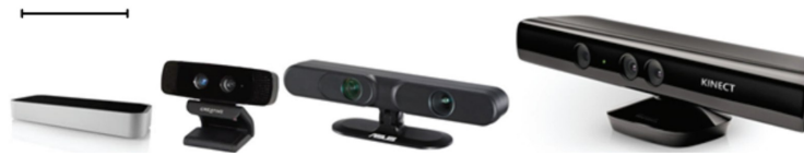
Figura 1.8: Diferentes dispositivos de detección de movimiento escalados aproximadamente para comparar sus tamaños: de izquierda a derecha Leap Motion Controller, Intel Creative Gesture Camera, Asus Xtion y Kinect; La barra de escala mide 10 cm [17].
