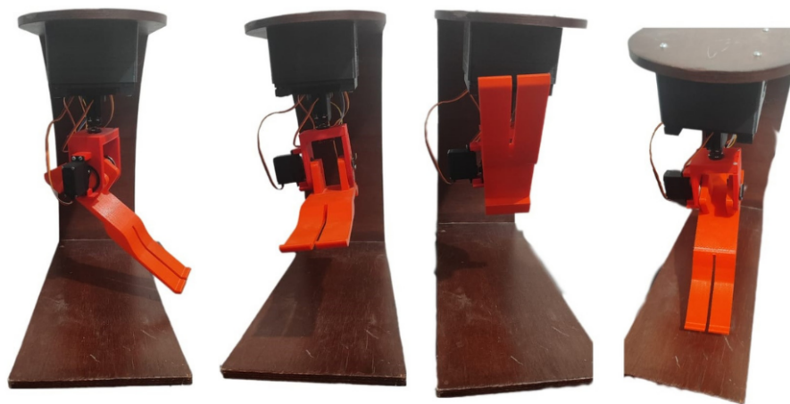
Figura 3.28: Mecanismo de tobillo de [55], construido en físico, para réplica de movimiento en tiempo real.
