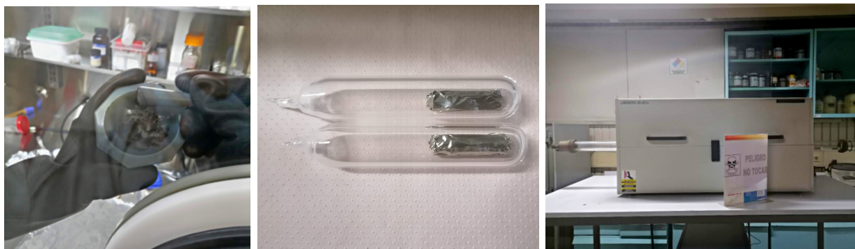
(a) Preparación de pastillas dentro de una cámara de guantes. (b) Cápsulas de cuarzo en vacío. (c) Horno tubular utilizado para el tratamiento térmico.
