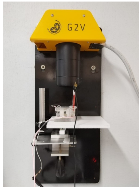
Figura 19: Posicionamiento de la celda electroquímica respecto al simulador solar.
