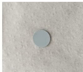
Figura 14: Substrato cerámico de CuO - Sb_2O_5 - SnO_2 .
