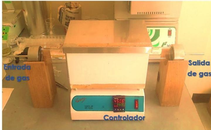
Figura 3.5. Sistema para el tratamiento térmico en atmósfera de aire.
