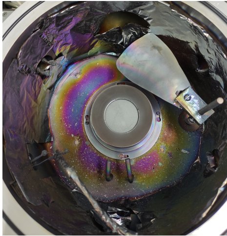
Figura 21: Sujeción de blanco y shutter en el sistema de erosión catódica.
